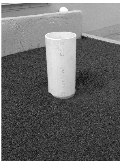
Figura 7. Vista de la pila circular original después de un ensayo.
