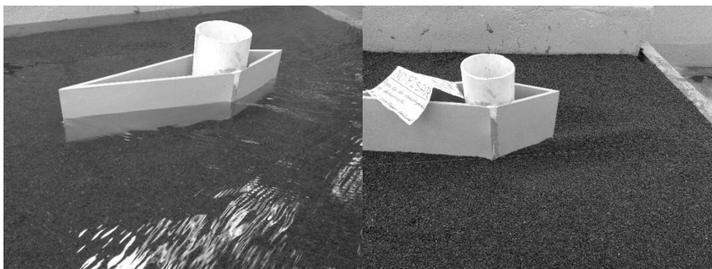
Figura 9. Vista de la pila con transición en V de 20° al frente y otra de 40° atrás de ésta, en pleno ensayo y después del mismo.
