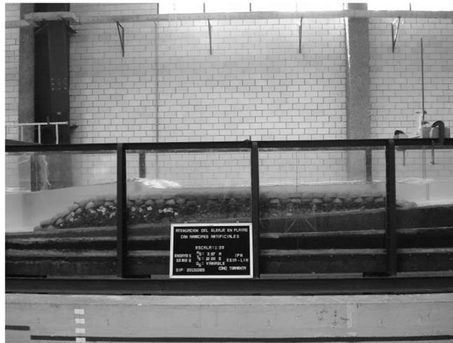
Figura 6. Sección de arrecife artificial de 50,00 m
