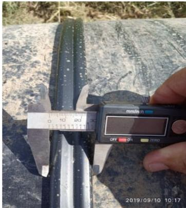
Figura 2. Ancho excesivo del cordón doble
