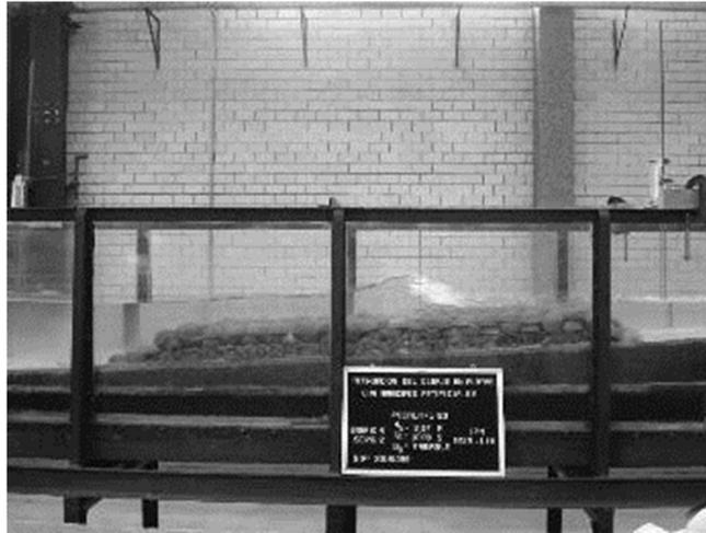
Figura 5. Sección de arrecife artificial de 34,00 m
