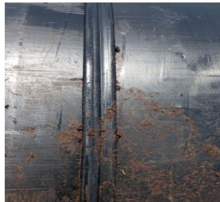
Figura 5. Doble formación del cordón y hendidura pronunciada
