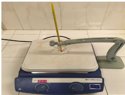
Figura 7. Diseño experimental para determinar punto de ebullición.
