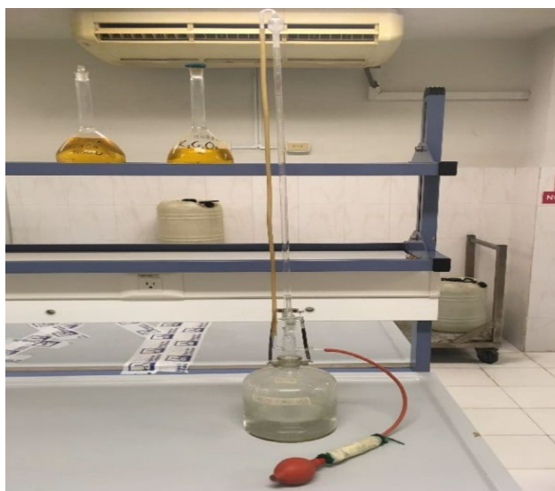
Figura 6. Diseño experimental para determinar dureza
