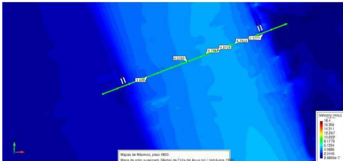
Figura 11. Resultados del parámetro velocidad del modelamiento en Iber.
