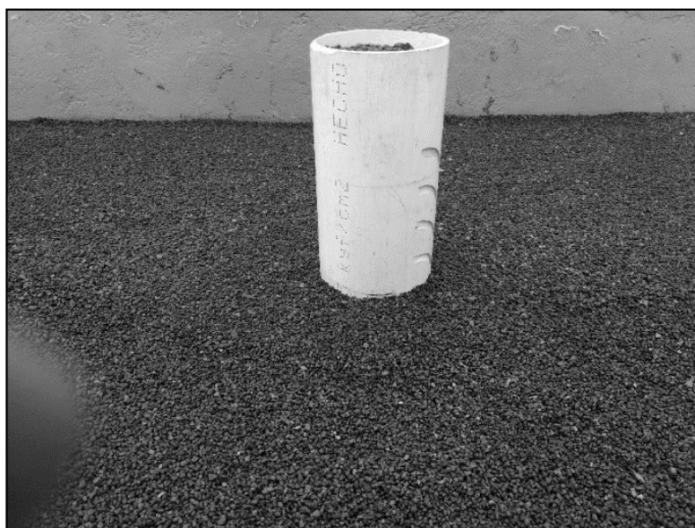
Figura 5. Modelo hidráulico de la pila.
