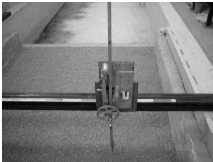
Figura 3. Limnómetro móvil, para medir la profundidad de socavación.
