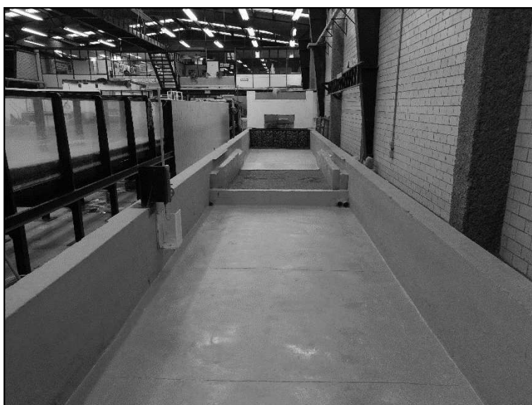
Figura 2. Canal de arenas del Laboratorio de Hidráulica.
