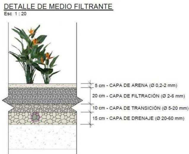
Figura 11. Detalle del medio filtrante HATL
