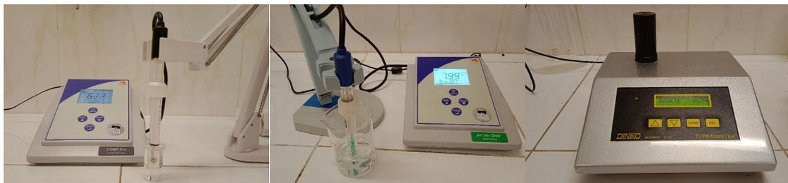
Figura 6. Conductímetro, pHmetro y Turbidímetro nefelométrico. (elaboración propia)
