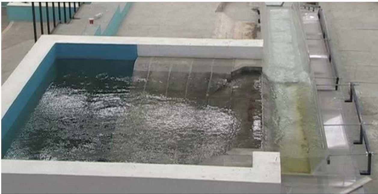
Figura 4.- Configuración general del modelo físico de la obra de excedencias del Proyecto de la Presa Vista Hermosa, Jalisco, México.
