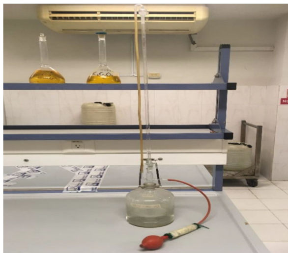
Figura 6. Diseño experimental para determinar dureza
