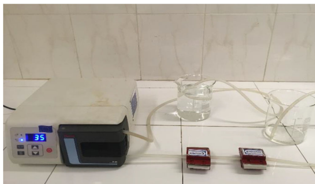
Figura 2. Sistema experimental para el tratamiento magnético
