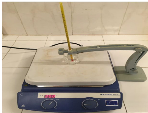
Figura 7. Diseño experimental para determinar punto de ebullición.
