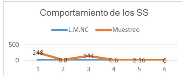
Figura 6. Comportamiento de los SS en análisis realizados al sistema de residuales de la EEA Fuente: Resultado de la Investigación
