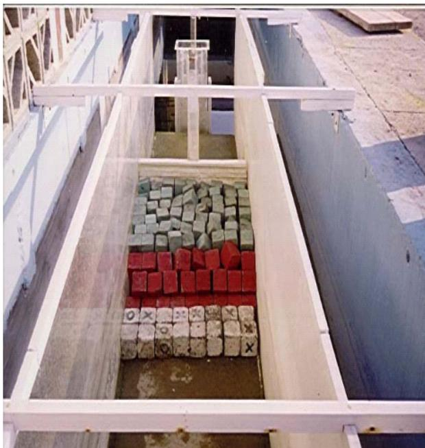
Figura 1. Vista del Sistema de Colección de rebases
