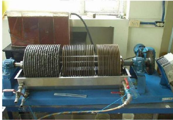
**Figura 4. Sistema de biodiscos para pruebas a escala de laboratorio**
