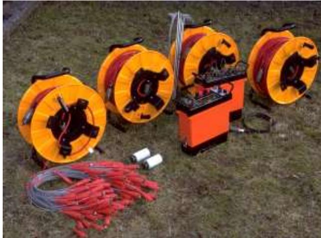
**Figura 2. Tomógrafo eléctrico**
