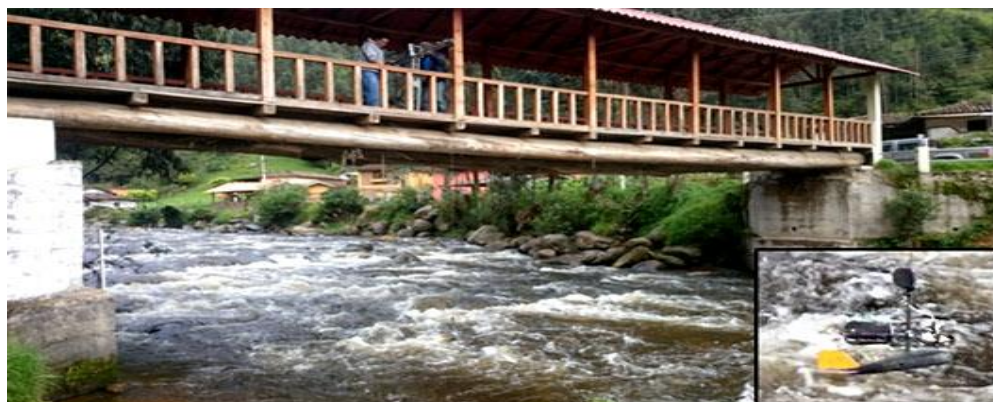
Figura 3. Aforo en la estación de Barabón con molinete de copas múltiples
