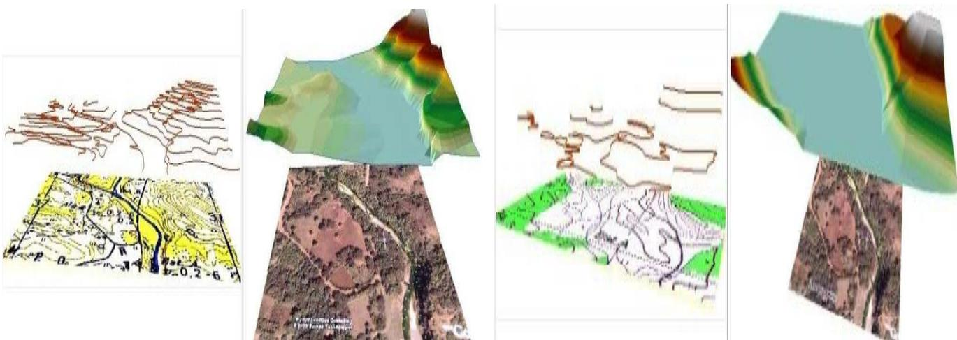
Figura 8. Curvas de nivel de los planos 1:25 000 y 1: 100 000 así como los Modelos Digitales del Terreno contruidos a partir de ellos.
