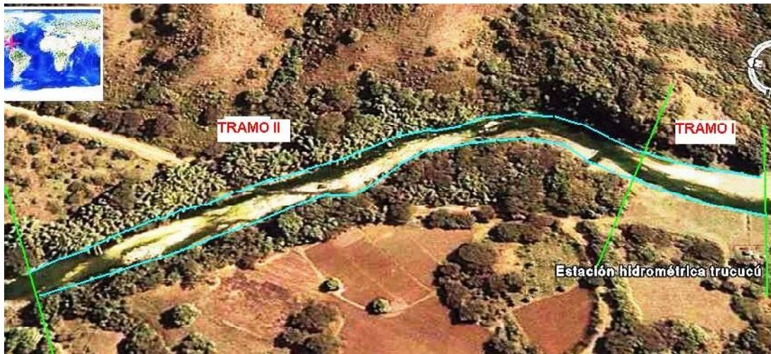
Figura 2. Representación de la frontera entre las llanuras de inundación y el cauce principal.
