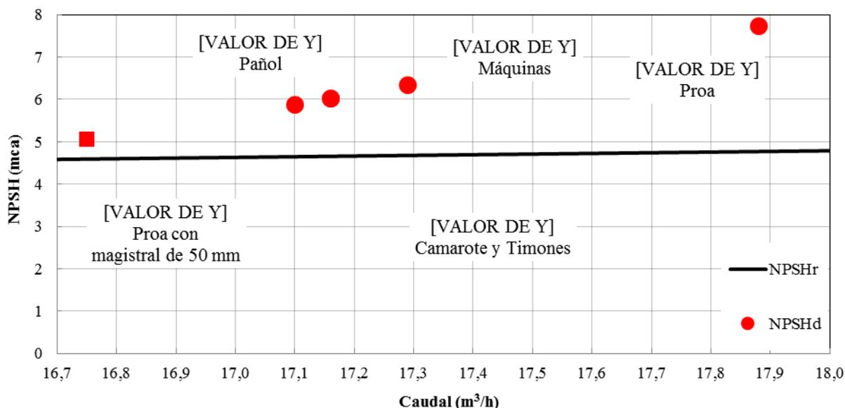
**Figura 7. NPSH de la succión de la bomba para cada escenario de achique**
