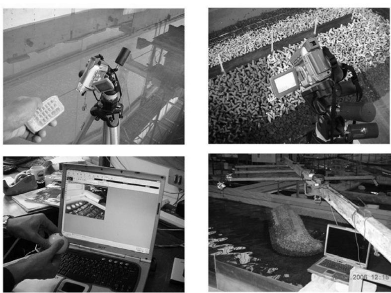
Figura 1. Cámara de video digital controlada remotamente acoplada a una Laptop para captura de datos (Phelp and Tulsi 2006)
