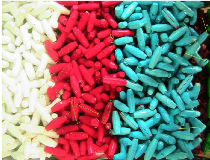
Figura 8. Medición de desplazamientos con el programa Armour Tracking
