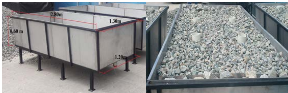
Figura 3. Medidas del reactor, material de soporte y pozos de muestreo
