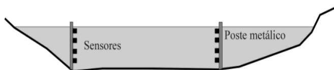
Figura 19. Postes de sensores para la estación hidrométrica "Paso Nacional"
