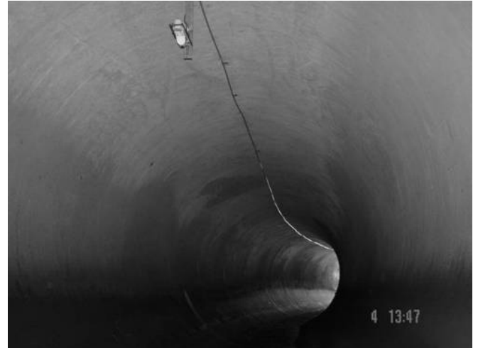
Figura 8. Medidor Doppler tipo radar
