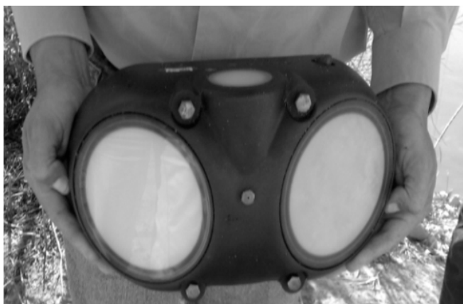
Figura 13. Sensor de efecto Doppler colocado en la estación de aforo "Agustín Melgar"
