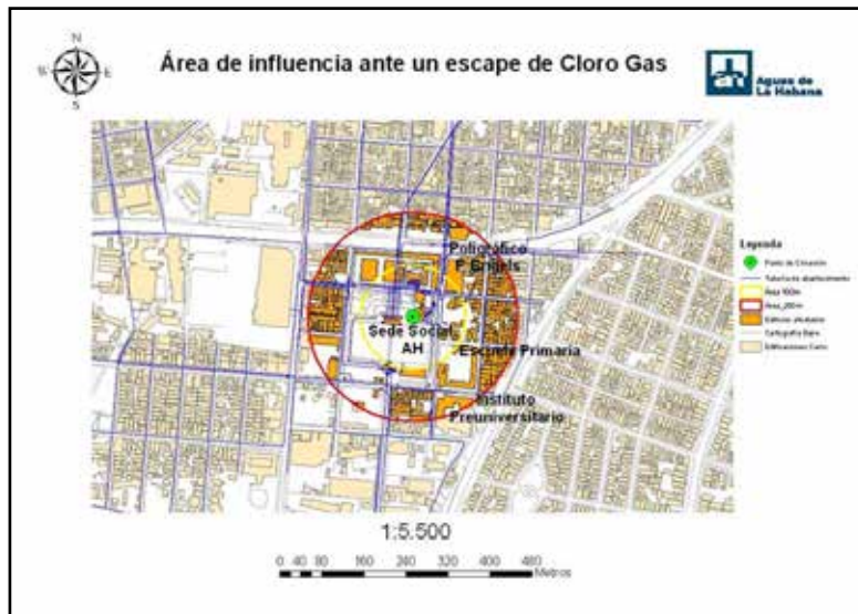
Figura 3. Infraestructura afectada por un posible escape de cloro gas
