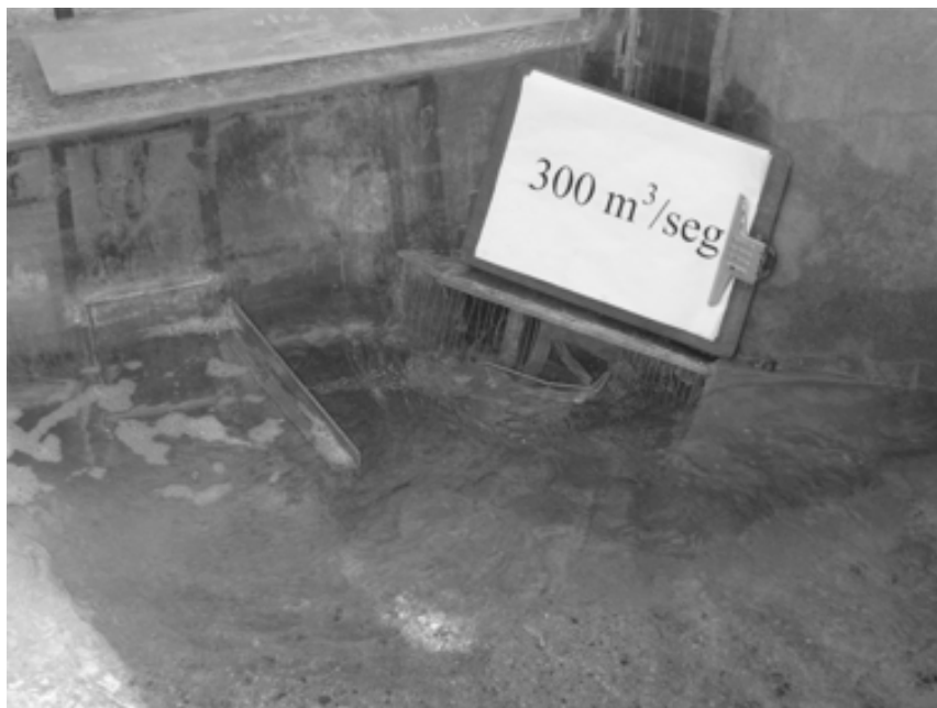
Figura 9. (fotografía 7). La solución final presentada en la figura 8 funcionando con uno de los caudales mayores.
