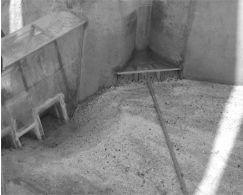
Figura 4. (fotografía 2). La ubicación y diseño inicial de la bocatoma del proyecto nuevo después de un ensayo que confirma la necesidad de modificaciones.
